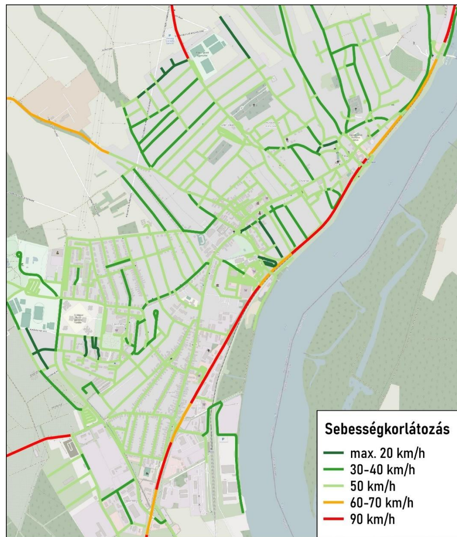
34. ábra: Sebességkorlátozással rendelkező útszakaszok
